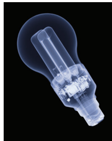
Figure 2.19 De l'argon, un gaz rare, se trouve à l'intérieur des tubes de cette ampoule fluorescente compacte.
