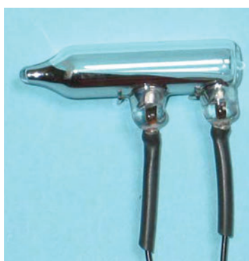
Figure 2.7 Le courant électrique circule quand le mercure recouvre les deux fils conducteurs, produisant ainsi une connexion électrique. Lorsqu'on incline le tube, la connexion est brisée et le courant ne passe plus.
