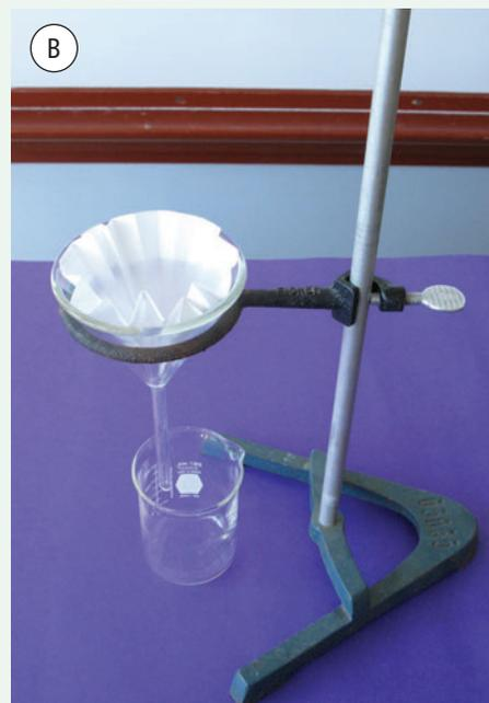
À l'étape 4 (A), du papier-filtre est placé haut dans l'entonnoir. (B) En ajoutant une goutte de solution, cela permettra au papier de tenir en place.
