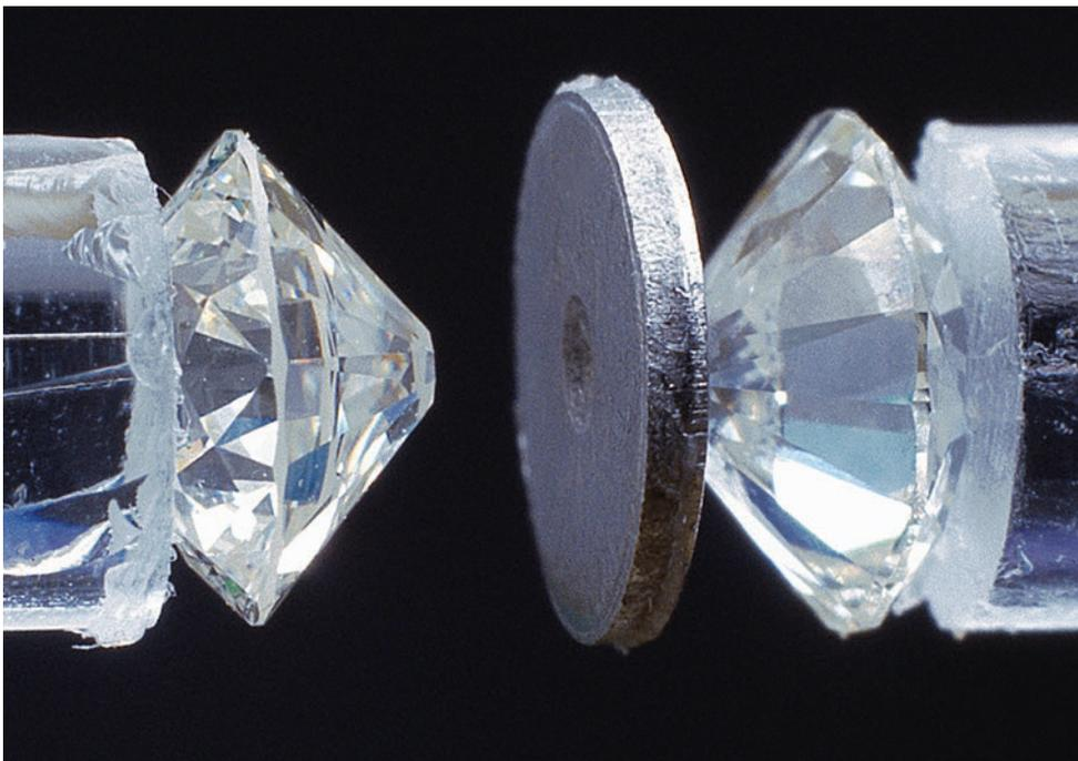
Deux diamants sont utilisés pour comprimer des échantillons de roche et de fer à une pression de un million d'atmosphères. Un laser chauffe ensuite les échantillons jusqu'à une température de 5 000 °C. Seuls les échantillons sont chauffés.
