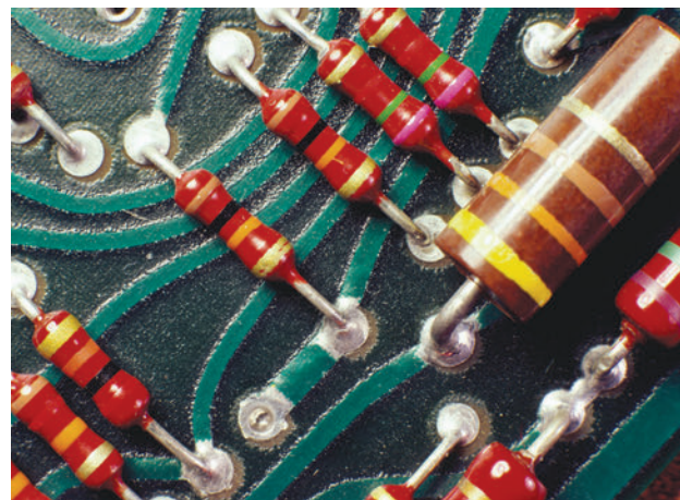
Figure 8.19 Les résistors servent à contrôler la tension et l'intensité du courant dans les circuits électriques.
