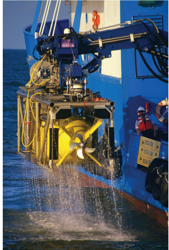
Figure 2.11 Les véhicules téléopérés sont commandés par des humains à partir de la surface. Ils peuvent collecter des données, des images et des objets.
