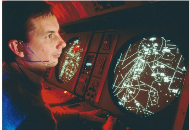
**Figure 4.32** Un contrôleur aérien utilise le radar pour guider les avions au moment des décollages et des atterrissages.
