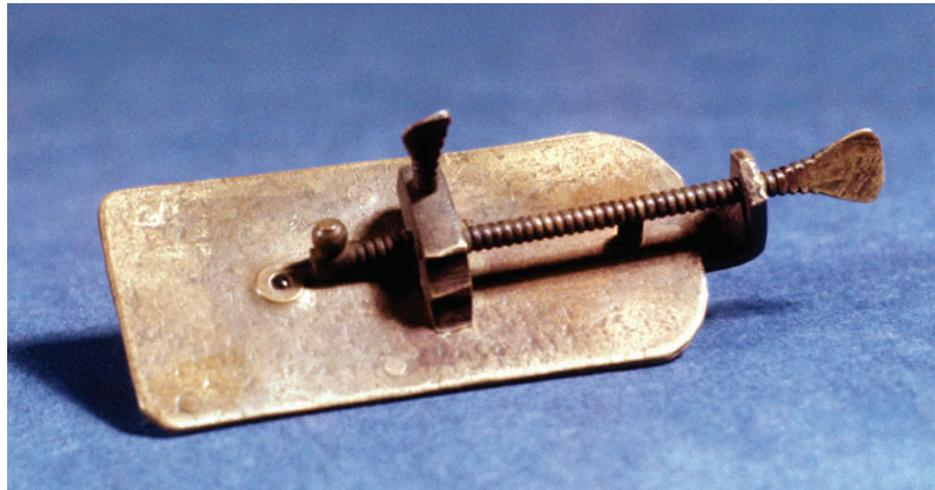
**Figure 4.5** Même si cet objet ressemble bien peu à un microscope, il a permis à Leeuwenhoek de découvrir de nombreuses « petites bestioles ». L’échantillon était placé sur la pointe de la vis et Leeuwenhoek l’observait à travers une lentille installée de l’autre côté de l’ouverture.
