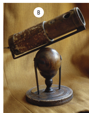
Figure 6.27 A) C'est en se servant de lentilles que Galilée a construit des lunettes astronomiques et qu'il a pu faire des découvertes sur l'Univers. B) Isaac Newton a amélioré l'invention de Galilée en installant un miroir pour capter et concentrer la lumière des étoiles. Ce dispositif est maintenant connu sous le nom de « télescope réflecteur ».
