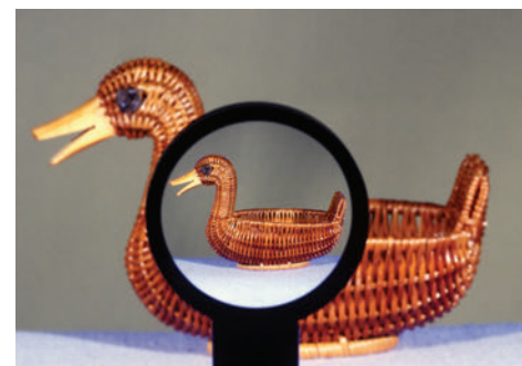
Figure 6.12 Une lentille concave ne forme jamais une image de grandeur égale ou supérieure à celle de son objet.
