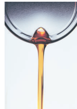
Figure 7.10 Selon sa température une huile pour moteur s'écoule plus ou moins bien et lubrifie donc plus ou moins bien les pièces du moteur.
