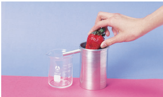
Figure 8.9 Le volume d'un objet de forme irrégulière peut être évalué en mesurant le volume d'eau déplacé par l'objet qui déborde du vase à trop plein.
