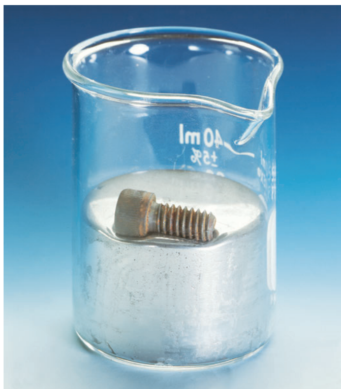
Figure 8.6A La masse volumique du mercure liquide est si élevée qu'il peut supporter un boulon de fer (solide). Une couche d'huile a été déposée à la surface du mercure pour prévenir toute évaporation dans l'air environnant, car le mercure est une substance très toxique.
