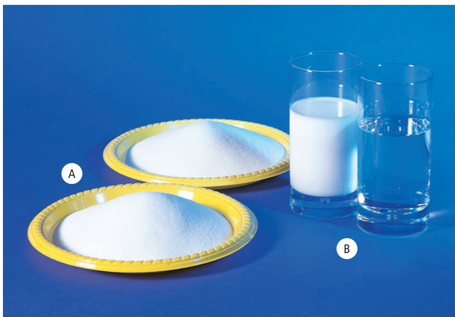
Figure 8.10 A) Le sel et le sucre présentés ici ont tous deux une masse de 0,5 kg et sont de la même couleur. Cependant, leurs masses volumiques sont différentes. B) L'eau de mer ressemble peut-être à de l'eau douce, mais sa masse volumique est plus proche de celle du lait : 1,03 g/mL.
