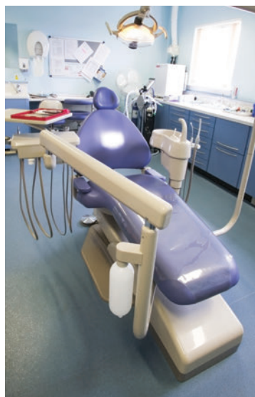
Figure 9.20 Une chaise de dentiste fonctionne à l'aide d'un système hydraulique qui en règle la hauteur et la position.
