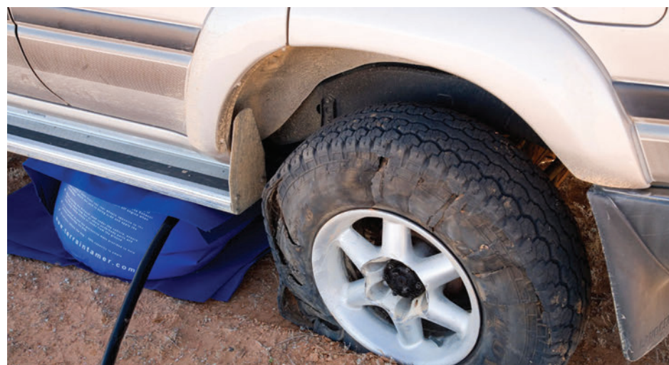
Figure 9.25 Les coussins gonflables sont placés sous le véhicule, puis gonflés pour le soulever.
