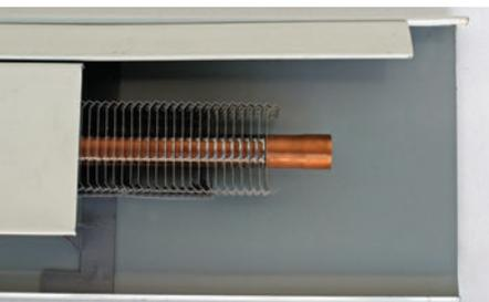
**Figure 6.18** Les plinthes de chauffage et les radiateurs chauffent l'air par conduction grâce aux particules d'air ambiant qui entrent en contact avec la surface en métal. L'air chauffé diffuse alors la chaleur dans la pièce, par convection.
