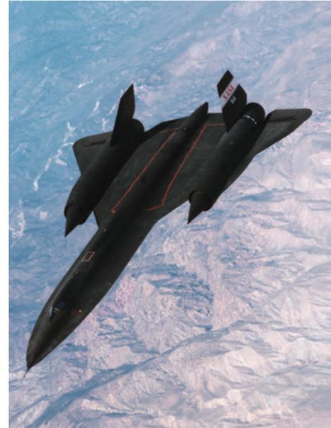
**Figure 6.11** Le SR-71 Blackbird peut voler à 3500 km/h. Sa surface réfléchit rapidement la chaleur, mais elle devient tellement chaude que l'avion s'allonge de quelques centimètres sous l'effet de la dilatation thermique.
