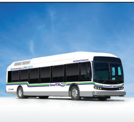
Figure 9.44 La plus récente génération d'autobus utilise une alimentation hybride composée d'une batterie et d'une pile à combustible fonctionnant avec un moteur électrique. Ces autobus sont deux fois plus efficaces que ceux roulant au diesel.
