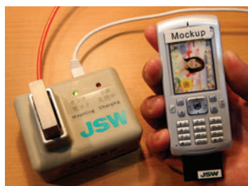
Figure 9.45 Ce micro-dispositif de stockage d'hydrogène sert à alimenter un téléphone cellulaire. Il s'agit d'un prototype présenté lors d'une exposition internationale sur les piles combustibles et les piles à hydrogène qui a eu lieu à Tokyo au Japon en 2007.
