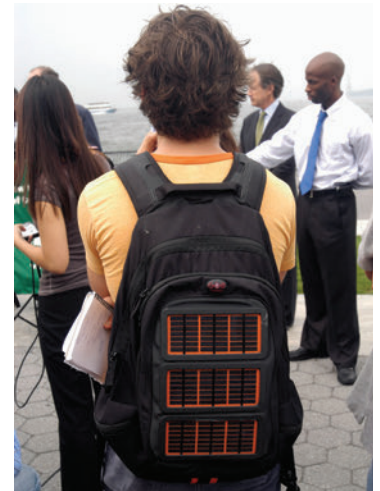
Figure 9.43 Les sacs solaires comportent des piles solaires qui rechargent les batteries des ordinateurs portables, des téléphones cellulaires et des lecteurs MP3.
