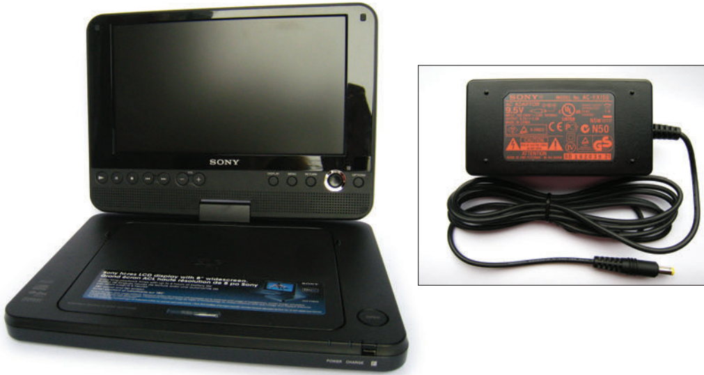
Figure 9.20 Ce lecteur DVD portable a un adaptateur qui peut être branché dans une prise murale. Il peut aussi fonctionner avec des batteries. Cet adaptateur alimente le lecteur avec une tension de 9,5 V et un courant de 2 A.
