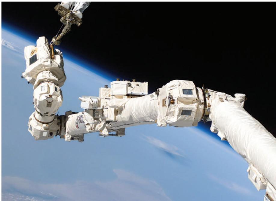
Figure 11.27 Les astronautes utilisent Canadarm 2 pour déplacer de lourdes charges, amarrer les navettes et effectuer des réparations et de l'assemblage.
