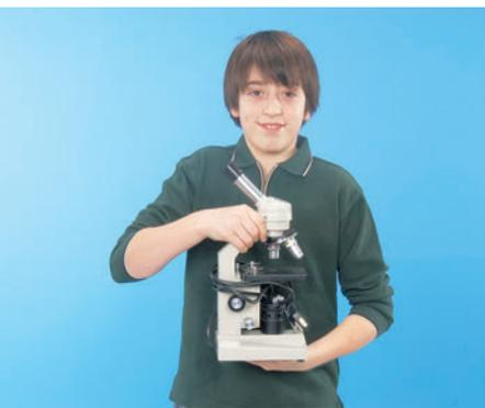
**Figure 10.2** Quand tu transportes un microscope, tiens-le toujours par la potence et par la base.
