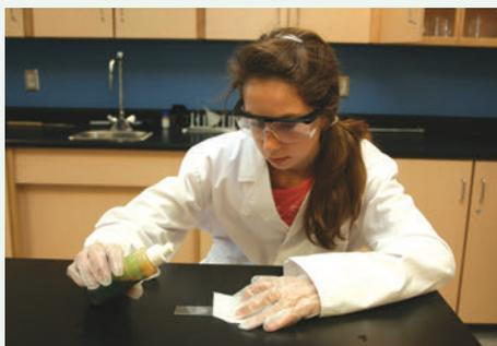
Mets une goutte de teinture d'iode d'un côté de la lamelle et appose un petit morceau d'essuie-tout de l'autre côté.
