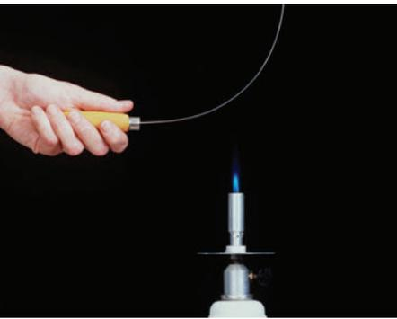
Figure 4.12 Lorsqu'il est chauffé, le bilame se tord.
