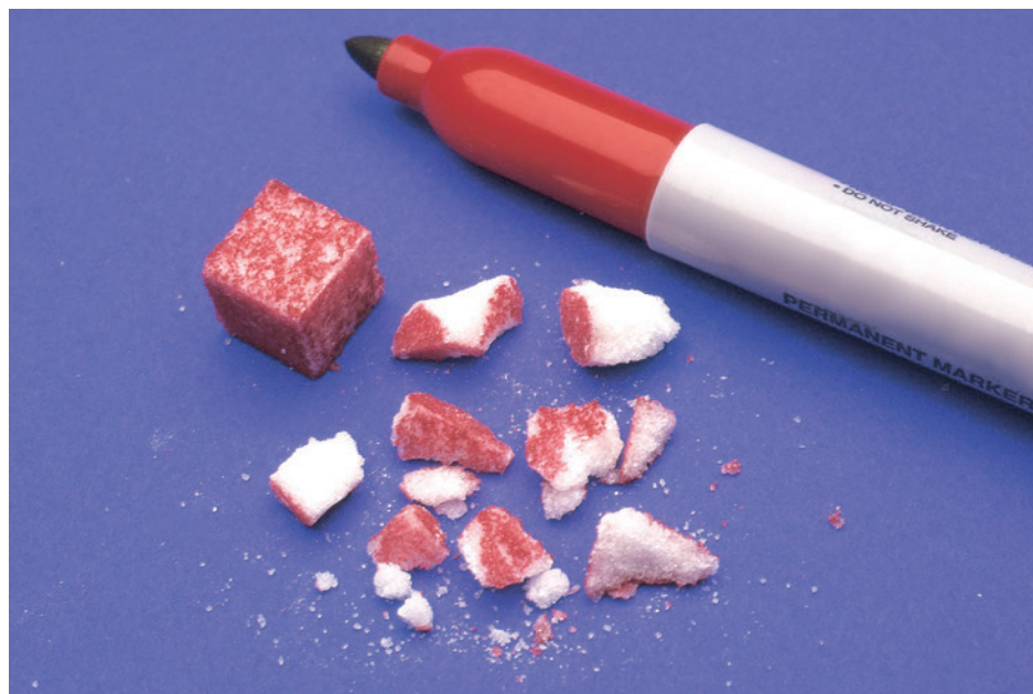
Figure 8.12 La taille et la masse de ces deux cubes de sucre sont identiques. Mais, le cube qui est brisé présente une plus grande surface de contact (de nombreuses zones rouges et blanches) pour l'interaction avec le solvant que le cube resté intact (seulement six faces rouges).
