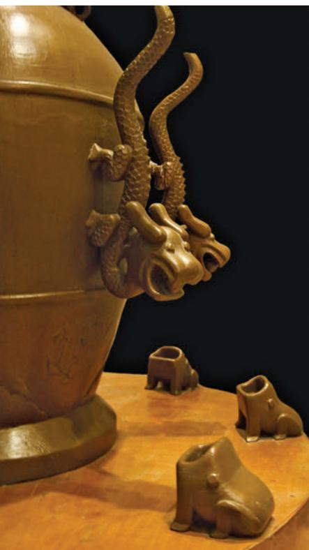
**Figure 11.15** Voici un ancien détecteur de tremblement de terre chinois. Les huit dragons placés sur cette urne ont chacun une petite bille dans leur gueule. Le mouvement entraîné par le tremblement de terre fait vibrer les billes qui tombent dans la gueule des crapauds. Ensuite, la direction du tremblement de terre est déterminée en regardant quel crapaud a une bille dans sa gueule.
