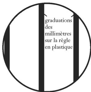
Le diamètre du champ de ce microscope est de 2,5 mm.
